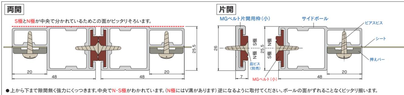
● 上から下まで隙間無く強力につつまます。中央でN・S極がわかれていて、(N極にはV溝があります) 逆になるように取付けてください。ポールの面がずれることなくピッタリ揃います。
